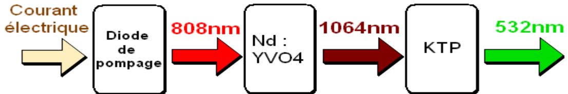
Figure III.20 : Vue synoptique d'un laser vert 532nm.
