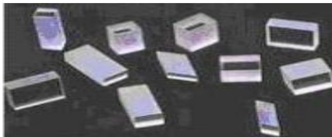
Figure III.17 : Cristaux Nd:YVO4 pour applications laser.
